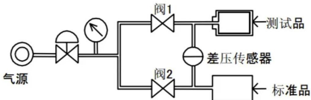
差压气密性检测通过在同一环境下同步测试被检产品和标准对照品，可以有效消除(排除)环境条件及被测产品本身结构引起的影响误差。不受其他干扰因素的影响，检测精度高，稳定性好，能够检测出微小泄漏。
