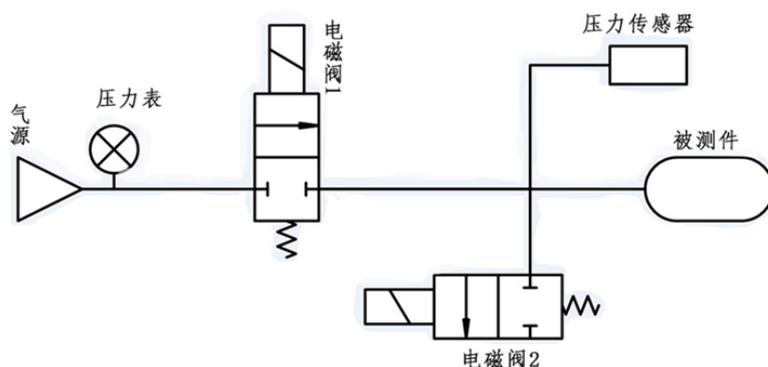
直压气密检测是以直压传感器为感测元件，向待测件内部充入/抽空规定压力的压缩空气或氮气，根据其内部压力的衰减值从而判断出待测件是否存在泄漏及泄漏大小。
